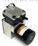
Helix是一款紧凑型高压涡旋泵,旨在实现满足最小的床旁诊断仪器的需求。 Helix涡旋泵可在挑战性的高海拔环境,和无法使用外部压缩空气的应用中实现高压操作。Helix涡旋泵可提供超过5.5 LPM的流量和高达100 PSI(6.9 bar)的压力,为性能至关重要且空间有限的台式诊断设备提供了最佳解决方案
