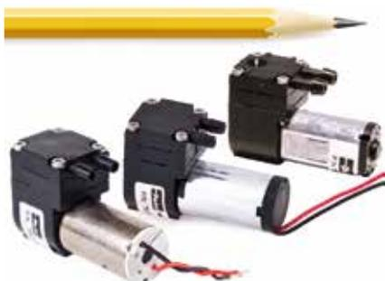
派克 T2-05 13.5 mm 宽微型隔膜泵由于其小巧紧密的包装，可安装在其他泵无法安装的位置。对 T2-05 流路进行优化以提供高流量，实现高效率，从而延长电池使用寿命。该泵功耗低、尺寸小并且重量轻，在便携式气体检测和医疗气体取样应用中起着关键作用。T2-05 泵 HE 和 LI 机型可为危险气体采样、典型的工业和采矿作业提供固有的安全性能。T2-05-IC 是为非爆炸环境气体检测仪器、用于伤口治疗和病人监护应用的便携式医疗设备而设计的。
