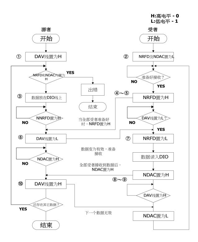
图 12-2 三线 GP-IB 握手流程图
