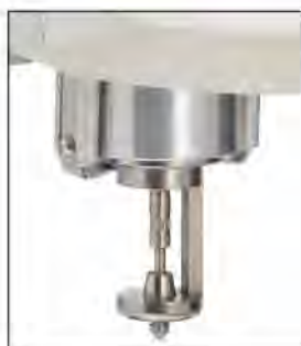
DV2THB 粘度计 (p8) 螺旋适配器 (p44) 滚珠轴承 悬挂系统 (p50)
