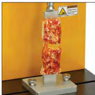
TA-PTF F M 披萨饼拉伸夹具 通过测量扯断样品所需的拉伸力和形变距离，来量化熟披萨饼的韧性。
