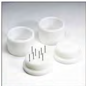
TA-FMBRA F 标准生面团罐套装 用来制备生面团测试样品，并测量生面团的韧性。
