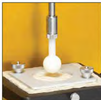
TA-DE F 生面团延展性夹具 用于固定一层生面团或扁平制品，测量样品拉伸时的抗断强度。需配合夹具基台使用。
