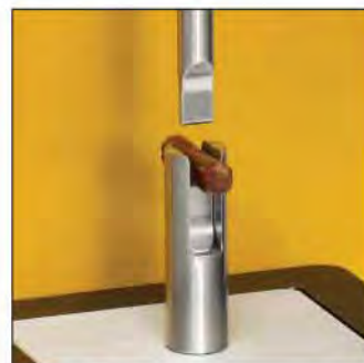
TA-VBJ F 咬断夹具 使用剪切测试来测量咬断肉类样品所需的力。需配合夹具基台使用。
