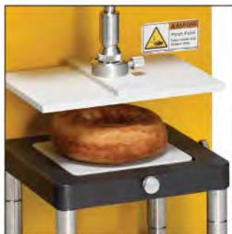
TA-CTP F 压缩平板夹具 可施加一个均匀压缩的力于样品，样品尺寸可达4×6英寸（10×15cm）。需配合夹具基台使用。
