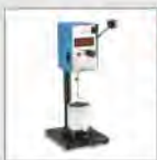
KU-2 斯托默粘度计 • KREBS 粘度 • 油漆/涂料 指定用仪器
