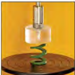
TA-11 弹簧系数测试 测量弹簧的负载vs距离
