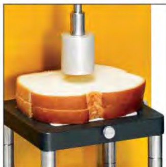
TA-AACC36 F AACC标准探头 用于测试面包坚韧性以及TPA分析。需配合夹具基台使用。
