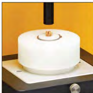
TA-DSJ F 生面团粘性夹具 生面团粘性测试的标准夹具，该粘性为处理生面团过程中的一个最重要参数。需配合夹具基台使用。
