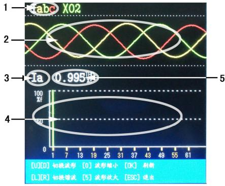
(图 11)波形显示及谐波分析界面
