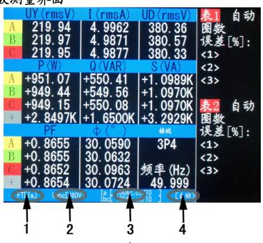
(图 8) 电参数测量界面
