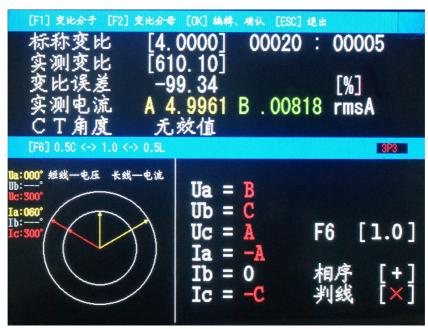
(图 10) 向量图查接线测变比界面
