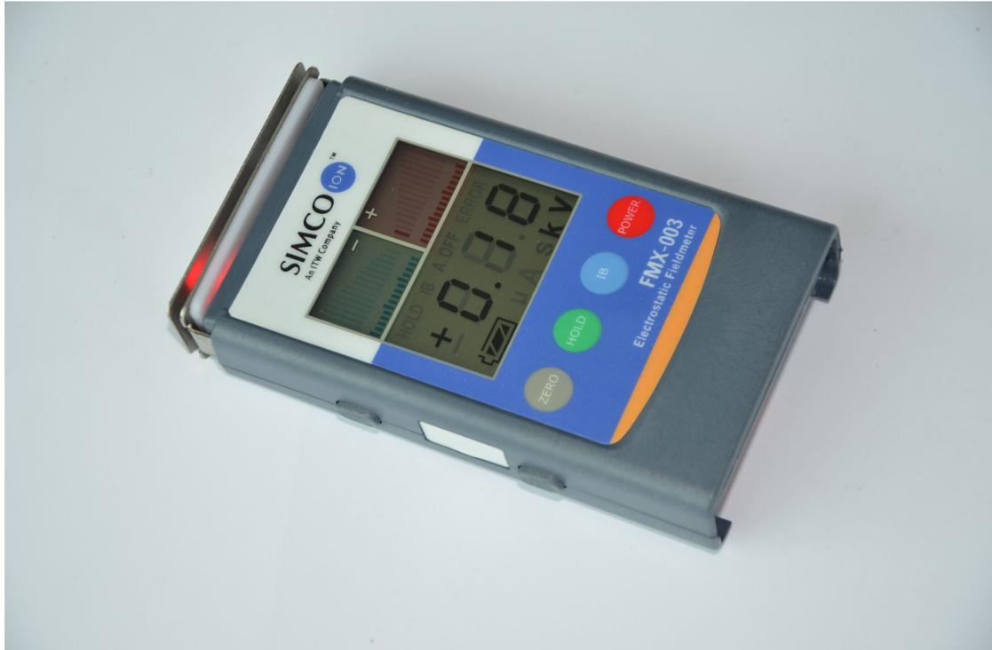
SIMCO FMX003 静电场测量仪，以非接触式方式，透过测量目标表面的静电位，来表示在其上的静电荷量。它可附加配件，测量离子产生器的离子平衡。
