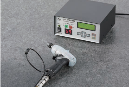
UTM-1500 (PS) : 圧力センサー内蔵タイプ 背面の継手にツールからの信号用エアホースを接続し、本体に内蔵された圧力センサーにより空気圧力信号を電気信号に変換し取り込みます。
