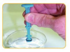
水质采样:检测水质时,将AccPoint水质采样器浸入水中至少3秒。
