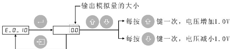
进入0-10V输出测试，显示窗显示输出模拟量的大小。
