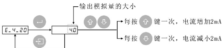
进入4-20mA输出测试，显示窗显示输出模拟量的大小。
