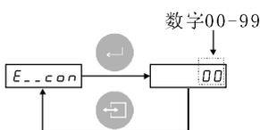
进入232测试项后，显示窗显示00(也有可能是00-99之间的任何数字，与上一次测试的数据有关)，短接RX与TX端子，显示窗的数字会在00-99之间跳动，断开RX与TX端子，数字会停止跳动。
