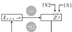
当IN1/IN2与输入公共点COMB接通时，对应1和2数码管右下角的小数点会被点亮。例如：短接IN1与COMB，显示器上显示
