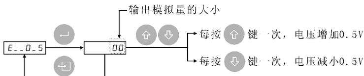
进入0-5V输出测试，显示窗显示输出模拟量的大小。
