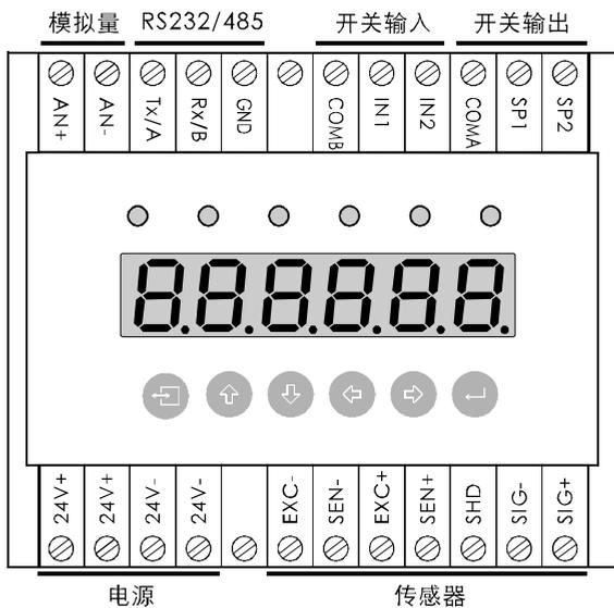
电源输入端：24V+，24V+，24V-，24V-
