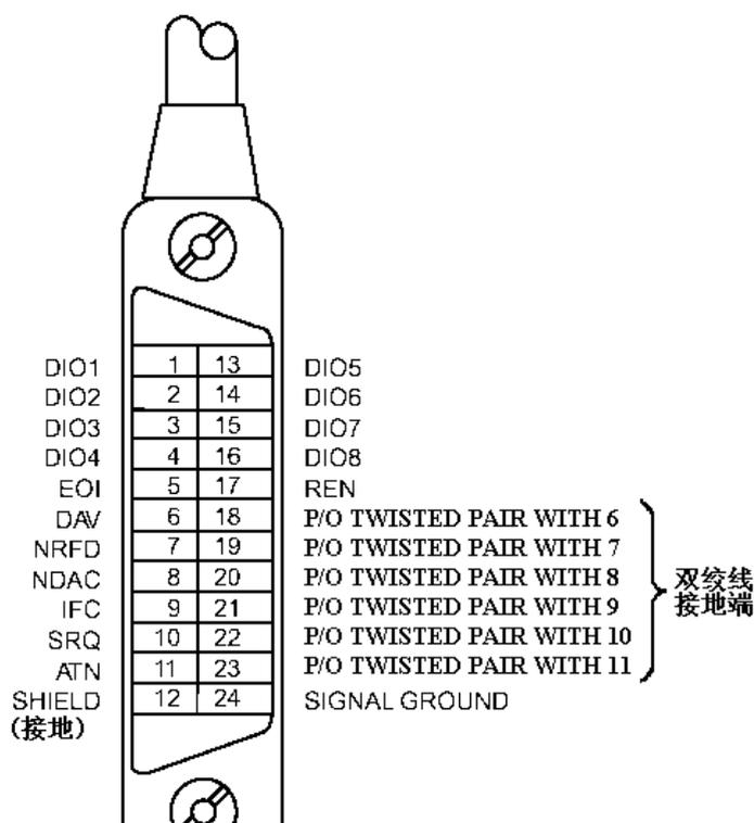
图 6-2 GPIB 接插件/管脚结构图
