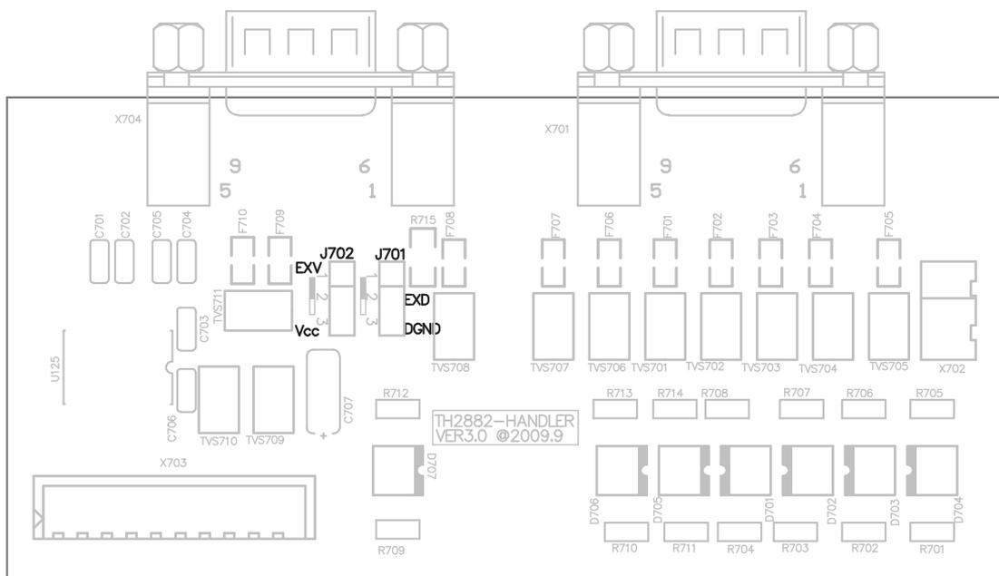
图 7-3 跳线在 HANDLER 板上的位置
