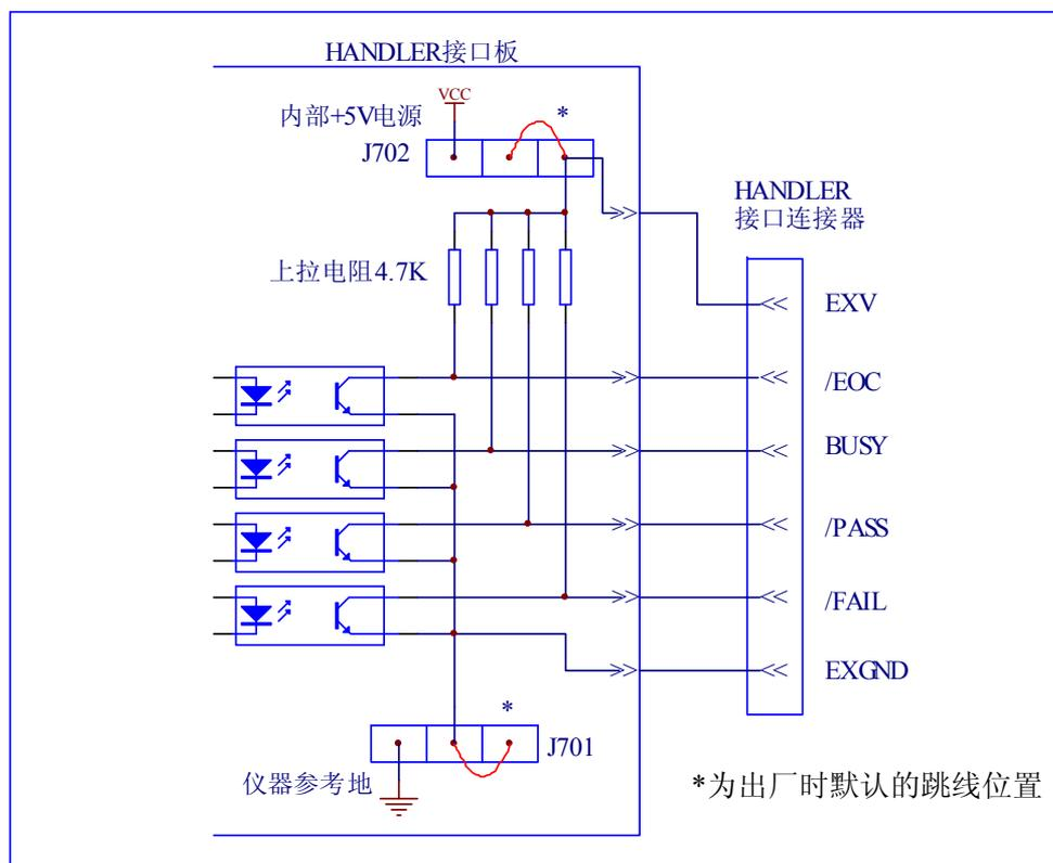
图 7-1 输出信号简化示意图
