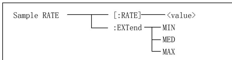
图 6-5 Sample RATE 子系统命令树
