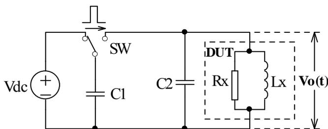
图 1-1 线圈脉冲测试原理简图
