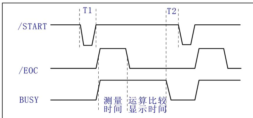
如上图所示的信号输出时序图，T1 是触发脉冲，脉宽最小为  $1\mu\text{s}$ ，T2 是测量结束后等待下一次触发的时间，最小为  $0\mu\text{s}$ 。对于/PASS 和/FAIL 信号在本次测量结束和下次测量出发前都是有效的。/STOP 的脉冲要求和/START 的触发脉冲要求一样。
