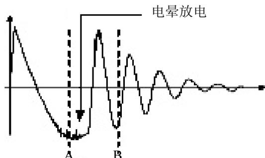
图 2-3 电晕放电示意图
