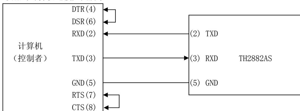
图 5-2 仪器与计算机连接简图
