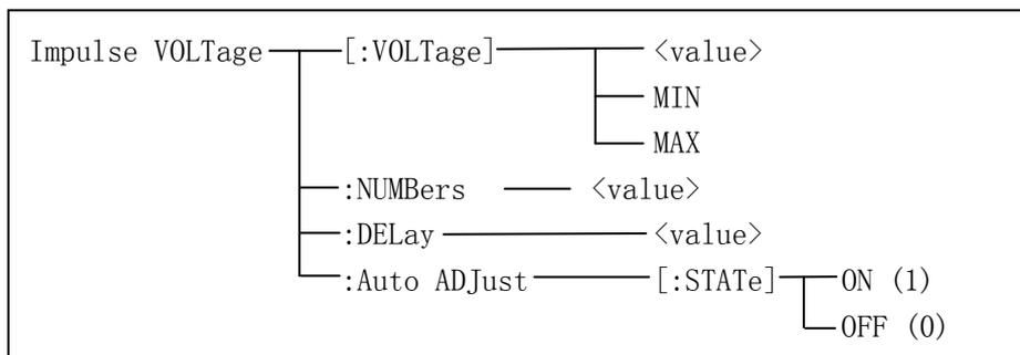
图 6-4 Impulse VOLTage 子系统命令树
