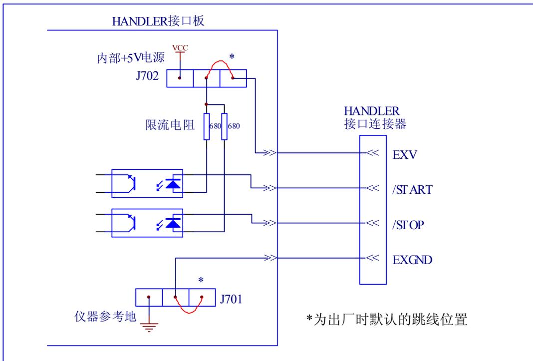
图 7-2 输入信号简化示意图
