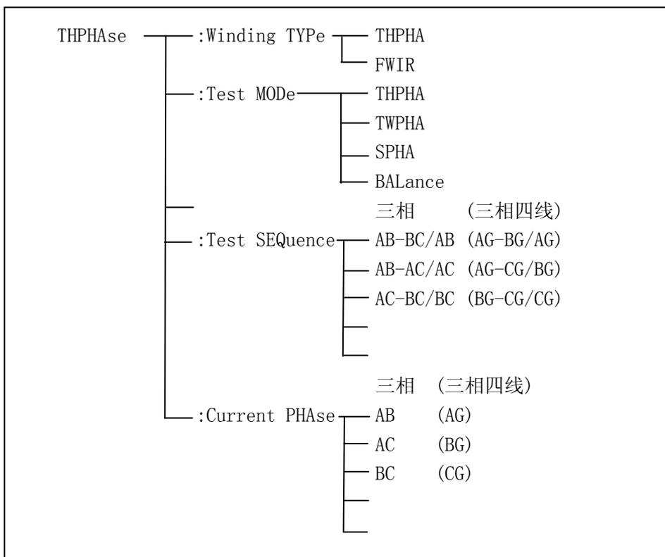
图 6-11 THree PHase 子系统命令树
