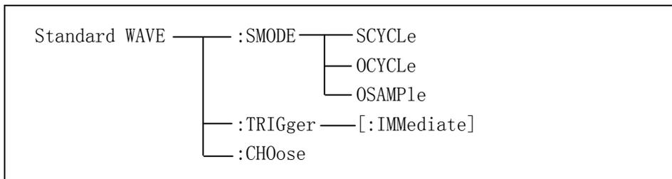
图 6-6 Standard WAVE 子系统命令树
