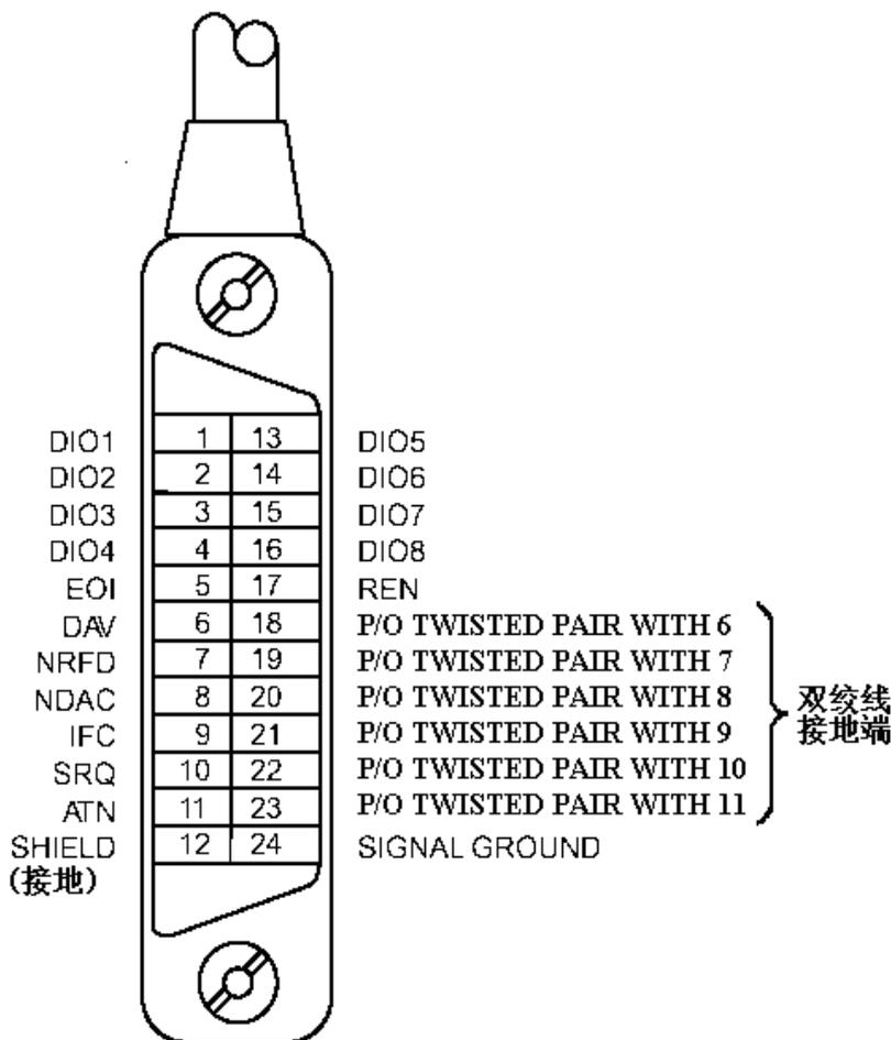
图 5-1 GPIB 接插件/管脚结构图
