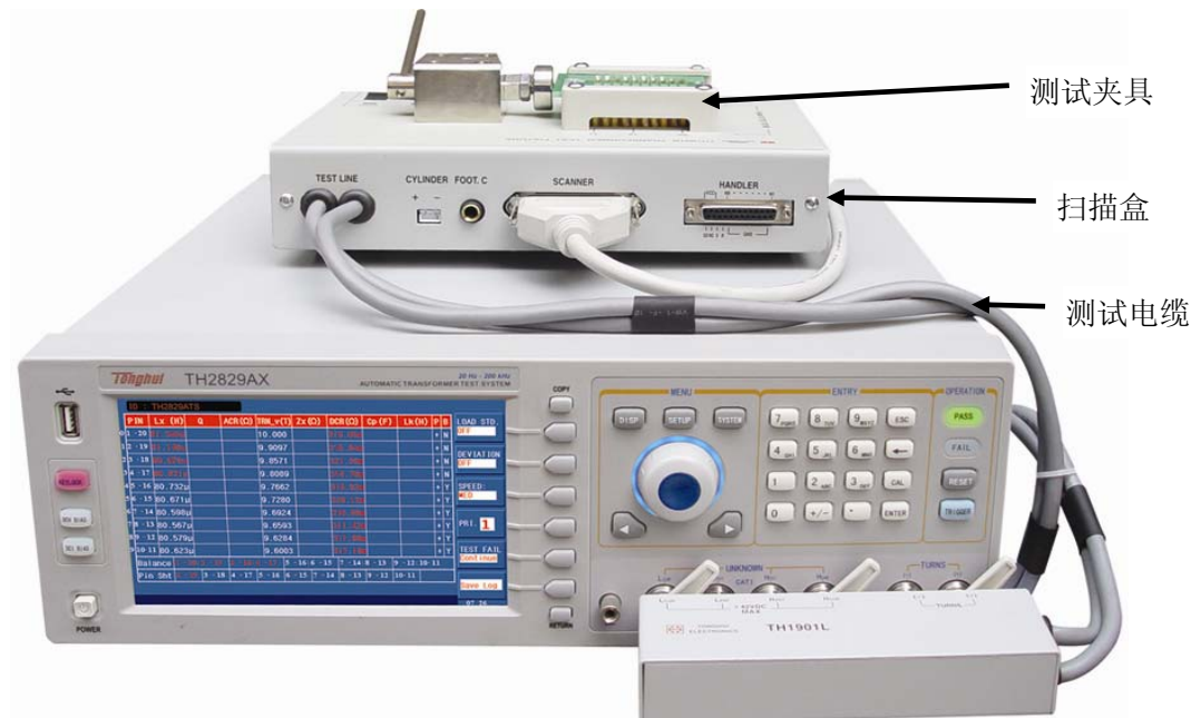
TH2829x702: 扫描盒测试电缆的连接
