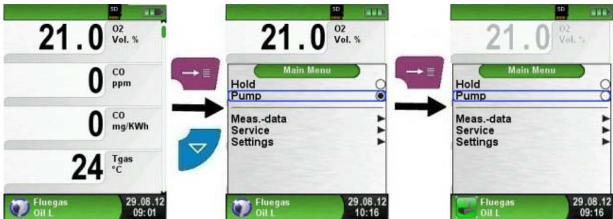
当泵被关闭时，泵运转的符号也将不在信息栏中显示。如果抽气泵停止的时间较长，在进行新一轮测试前要重新在新鲜空气中自校。
