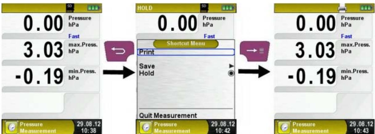
一旦执行打印命令，实时的测量数据就会打印出来，而测量工作还在正常进行（即多任务处理模式）。
