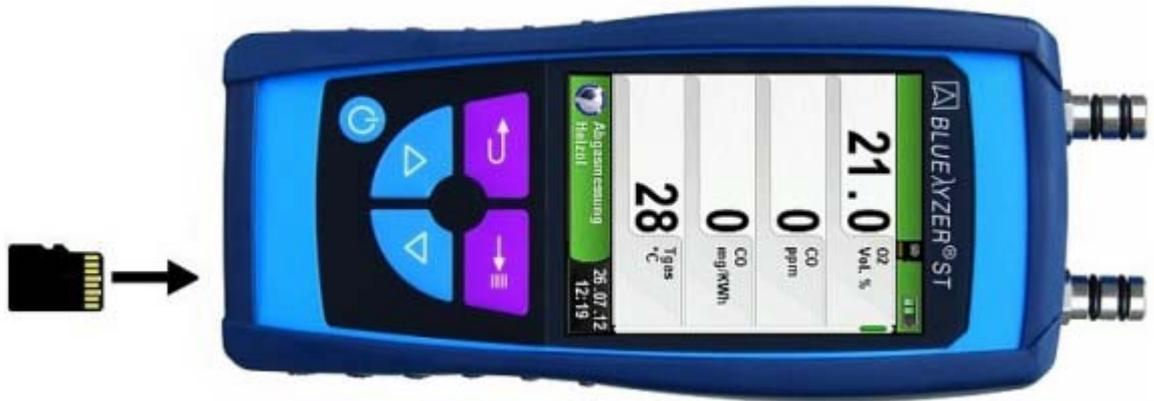
**警告** 使用不匹配的 SD 卡可能导致卡槽的损坏。
