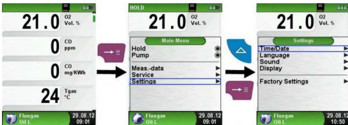
图 8：从某个测量程序的主菜单中选择设置子菜单（例：烟气测量）
