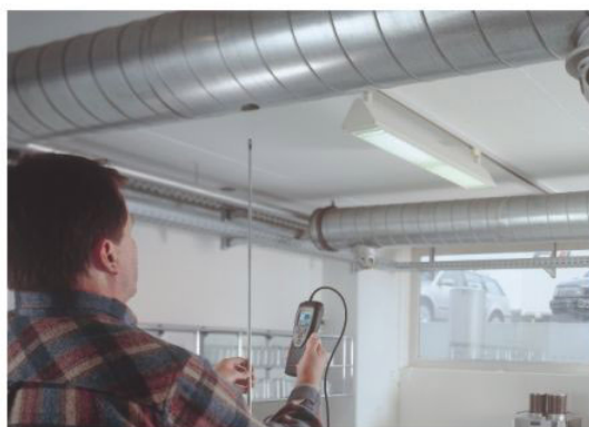
testo 425, 检测厨房的排风量
