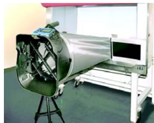
8375M 直接测试生物安全柜的进流量(当使用生物安全柜套件 BSC Hood Kits)
