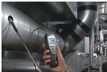
testo 416，监测排气管道的体积流量
