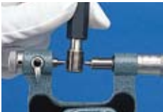
图为已安装好匹配的可更换选项测砧和心轴探针的 116-101
