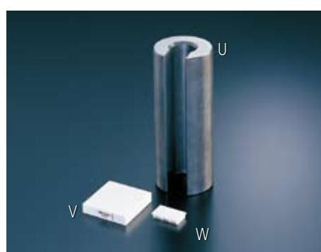
U: 用于深度千分尺的圆柱基准量块 ( $\varnothing 60 \times 150\text{mm}$ )
