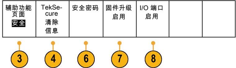
5. 按侧面菜单中的 **执行清除设置和参考信息**。如上所述，这将清除示波器参考波形和设置存储器位置中的数据。
