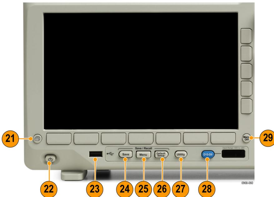
21. **Print（打印）**。 按此按钮即可打印到所选的打印机。
