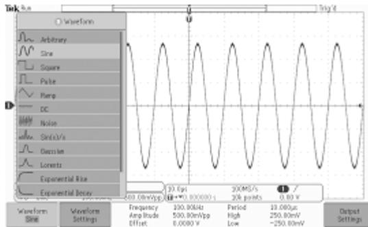
3. 按 AFG 下方菜单中的**波形设置**按钮设置所需波形的频率、周期、幅度、偏置和高电平。
