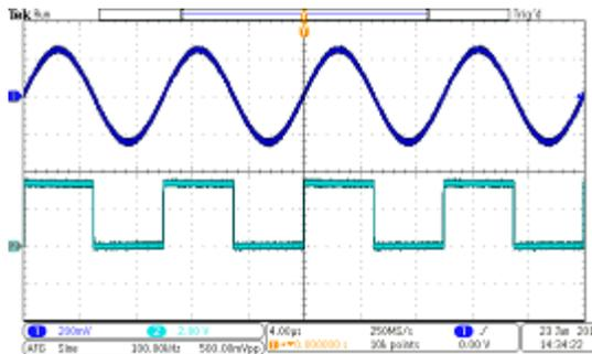
通道 1 正弦波表示 AFG 的输出。通道 2 正弦波表示 AFG 同步脉冲的输出。其来自 AUX OUT 端口。
