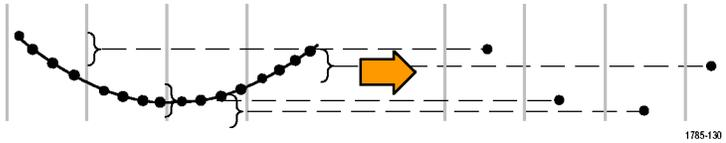
**包络**模式在所有采集中查找最高和最低记录点。包络模式对每个单独的采集使用峰值检测。
