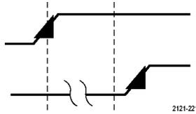
将边沿 A 事件（主）触发和 B 事件（延迟）触发组合以捕获更复杂的信号。（见第97页，使用序列触发（A（主）和 B（延迟）））
