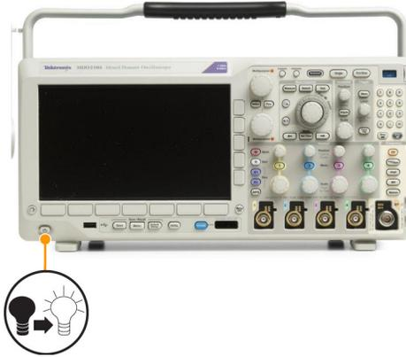
5. 关闭示波器电源并移除 USB 闪存或硬盘驱动器。
