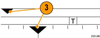
4. 波形记录视图显示相对于波形记录的触发位置。线的颜色与选定波形颜色相对应。括号显示屏幕上当前显示的记录部分。
