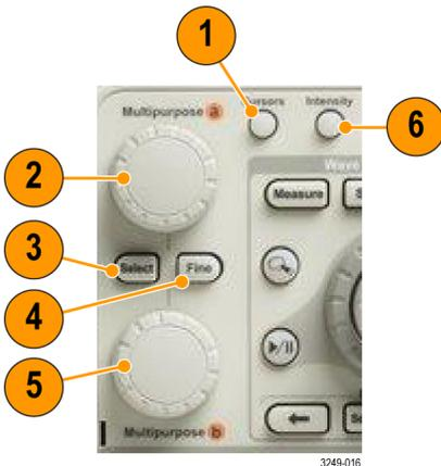
1. **光标**。 按一次可激活两个垂直光标。 再按一次将关闭所有光标。 按住此按钮即可显示光标菜单。 使用菜单选择光标功能，如类型、来源、方向、链接状态和单位。
