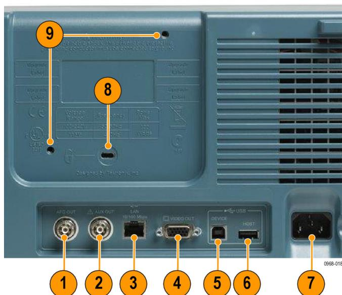
1. **AFG OUT (任意波形发生器输出)**。使用 AFG OUT (任意波形发生器输出) 端口传输来自任意函数发生器的信号。
