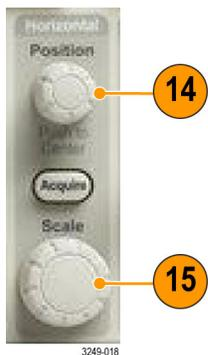
14. **水平位置**。 旋转此旋钮可以调整触发点相对于采集的波形的的位置。 延迟开启时，按此按钮即可对准中心位置。 延迟关闭时，按此按钮即可设置为 10%。
