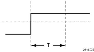
在指定时间内没有检测到脉冲时触发。信号处于设定值以上或以下超过一定时间。
