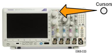
在本例中，选定的波形上将出现两个垂直光标。旋转**通用 a**时，可以将一个光标向左或右移动。旋转旋钮**通用 b**时，可以移动另一个光标。
