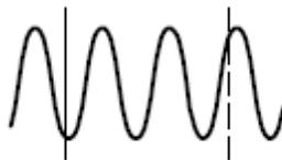
当同时存在垂直和水平光标时，读数中的方形和圆形与通用旋钮相对应。
