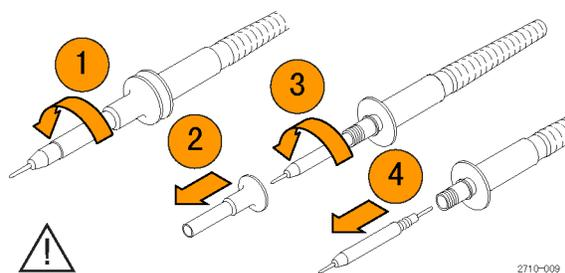
使用探头之前，请紧固绝缘体和新端部。
