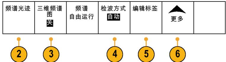
3. 按“**三维频谱图**”调出一个侧面菜单，用来启用和配置三维频谱图显示。
