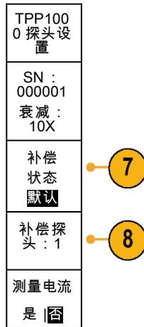
在 MDO3000 系列示波器上补偿 TPP0250/TPP0500B/TPP1000 探头时：
