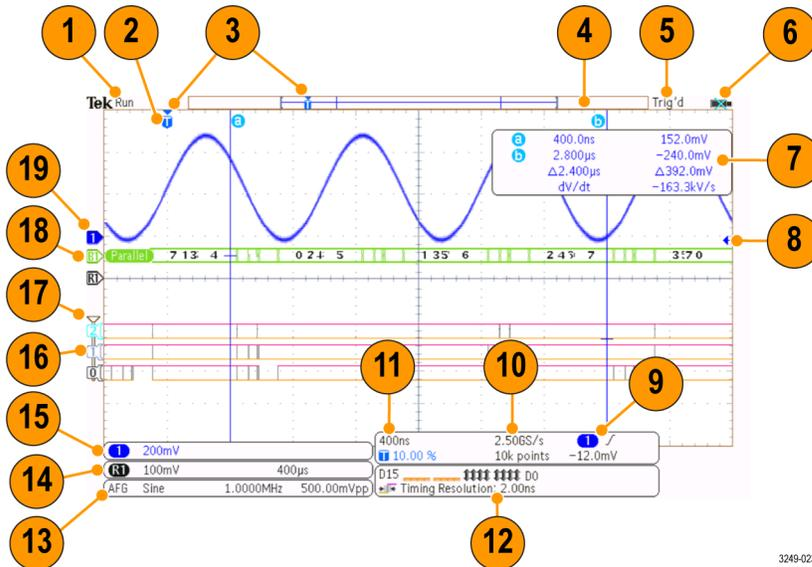
1. 采集读数显示采集运行、停止或采集预览有效的时间。运行 = 采集已启用。停止 = 采集未启用。滚动 = 滚动模式 (40 ms/div 或更慢)。预览 = 示波器停止或处于触发之间。可以改变水平或垂直位置或刻度以查看下一个采集信号的概况。A/B = 使用平均采集模式时, B 显示要平均的总采集个数 (用“采集模式”侧面菜单设置), A 显示达到此总数的当前进度。
