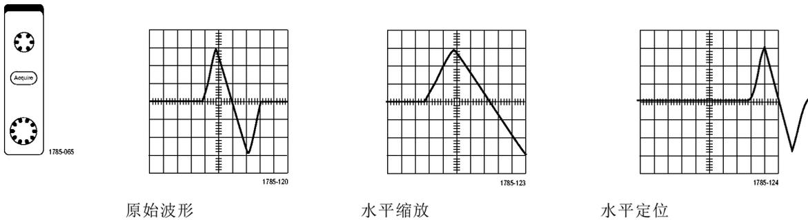
使用垂直控制选择波形、调整波形垂直位置和标度，并设置输入参数。根据需要多次按通道菜单按钮（1、2、3 或 4）以及相关的菜单项，可选择、添加或删除波形。
