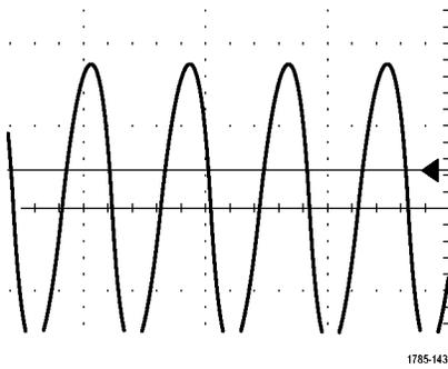
9. 触发读数显示触发源、斜率和电平。其他触发类型的触发读数显示其他参数。
