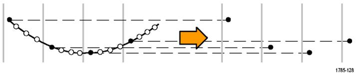
**峰值检测模式**使用了两个连续捕获间隔中包含的所有取样的最高和最低点。该模式仅可用于实时、非内插的取样，并且在捕获高频率的毛刺方面非常有用。
