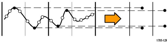
**高分辨率**模式计算每个采集间隔所有取样值的平均值。该模式也只能用于实时、非内插取样。高分辨率模式提供了较高分辨率、较低带宽的波形。
