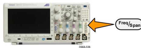
2. 按侧面菜单中的**中心频率**，使用**通用 a** 旋钮或示波器键盘输入所需的中心频率。如果使用键盘，也可以使用出现的侧面菜单选择来输入单位。
