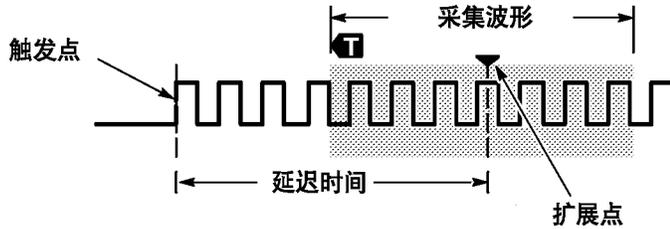
当“延迟”设为“开启”时，顺时针旋转“水平位置”旋钮增加延迟。触发点将向左边移动，最终达到采集的波形之外。然后，可调整“水平比例尺”旋钮来采集屏幕中央感兴趣区周围的更多细节。
