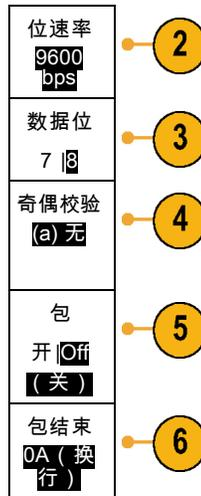
RS-232 解码显示出字节流。可将流组织到带有包结束字符的包中
