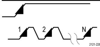
**事件。**在 A 事件发生之后，触发系统找到指定数量的 B 事件后，才能触发和显示波形。
