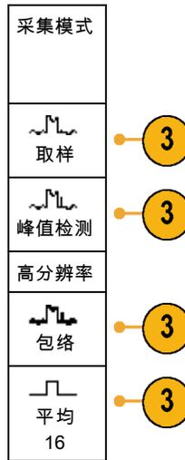
**说明：**“峰值检测”和“高分辨率”模式充分利用示波器在较低扫描速率下会丢弃的取样点。因此，只有当前取样速率低于可能的最大取样速率时，这些模式才会工作。一旦示波器开始以最大取样速率进行采集，“峰值检测”、“高分辨率”和“取样”模式看起来都会一样。可通过设置“水平标度”和“记录长度”来控制取样速率。
