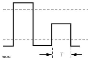
触发脉冲振幅，脉冲振幅通过第一个阈值，但重新通过第一个阈值前未能通过第二个阈值。可以检测负欠幅或正欠幅（或两者），或仅仅那些宽于、少于、大于、等于或不等于特定宽度的欠幅。欠幅触发主要用于数字信号。
