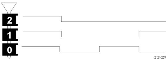
18. 总线显示表示串行总线或并行总线解码后的包级别信息。总线指示器显示总线编号和总线类型。
