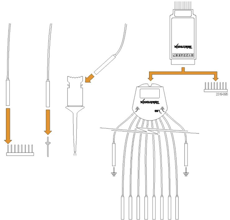
2. 将一根或多根接地导线连接到电路接地点。
