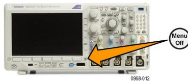
15. 再按“光标”。该操作将关闭光标。屏幕不再显示光标和光标读数。
