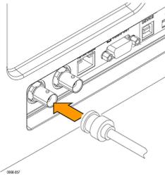
若要查看 AFG 输出, 请将电缆的另一端连接至示波器正面的输入通道之一。
