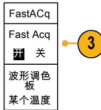
5. 旋转通用 a 旋钮选择所需的显示调色板。
