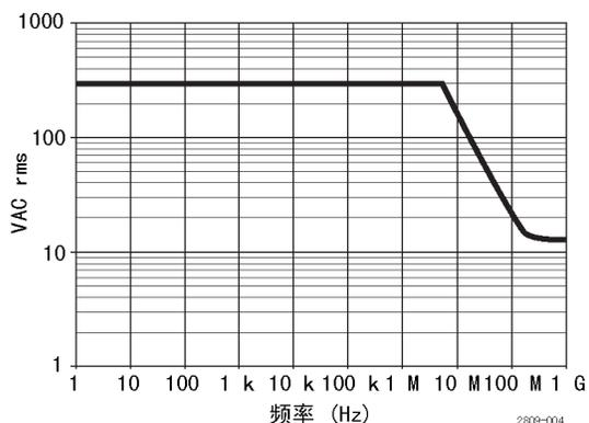
在进行浮动测量时，请参考上面的基准引线降额曲线。
