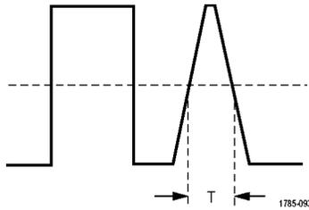
在小于、大于、等于或不等于指定时间的脉冲上触发。此外，可以在脉冲宽度位于两个指定的不同时间以内或以外时触发。可在正脉冲或负脉冲上触发。脉冲宽度触发主要用于数字信号。
