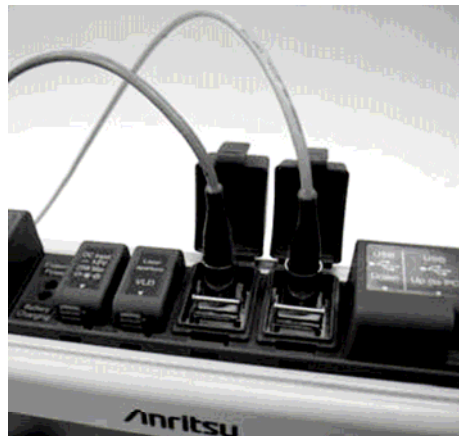
图 2-7：将光纤跳线连接到测量端口
