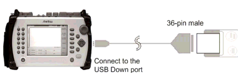
图4-19：连接BL-80R II打印机
