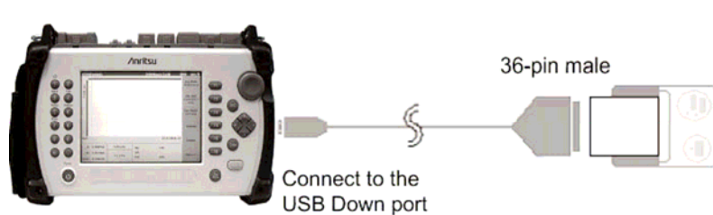
图5-20：连接BL-80R II打印机
