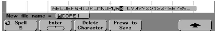
旋转输入旋钮，选择输入示于该软键上方“New file name =”行中和 **Spell** 软键中高亮部分的字符。
