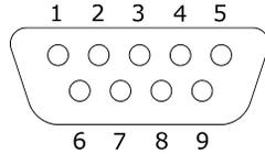
示波器 RS-232 端口引脚输出（面向 DB9 插入式连接器）
