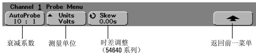
**探头衰减** 如果在模拟通道上接有 AutoProbe 自感应探头（例如 10073C 或 10074C），示波器将自动把探头配置到正确的衰减系数。在前面的图中，示波器检测到有一个 AutoProbe 10:1 探头。
