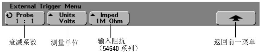
**探头衰减** 旋转输入旋钮设置在 **Probe** 软键中显示的用于所连接的探头的衰减系数。可以按照 1-2-5 顺序设置衰减系数，最小为 0.1:1，最大为 1000:1。
