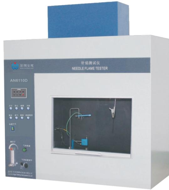
在产品中，由于故障条件使元件或零件过热，不良接触等情况下均可能引起火焰，它可能又辐射到附近的零件上，针焰试验是模拟产品内部在故障条件下所产生的小火焰，用模拟技术评定着火危险性。对于小零件（或元件）灼热丝试验或水平一垂直燃烧试验方法不适合时，可引用针焰试验方法。如果试验样品在进行灼热丝试验时起燃，则所产生的燃烧危险情况还需用针焰试验。
