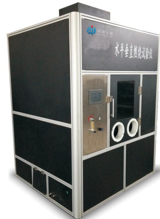
按照UL1581 sect 1080.1~1080.14标准生产，完全符合VW-1 (Vertical-specimen) Flame Test燃烧试验标准。
