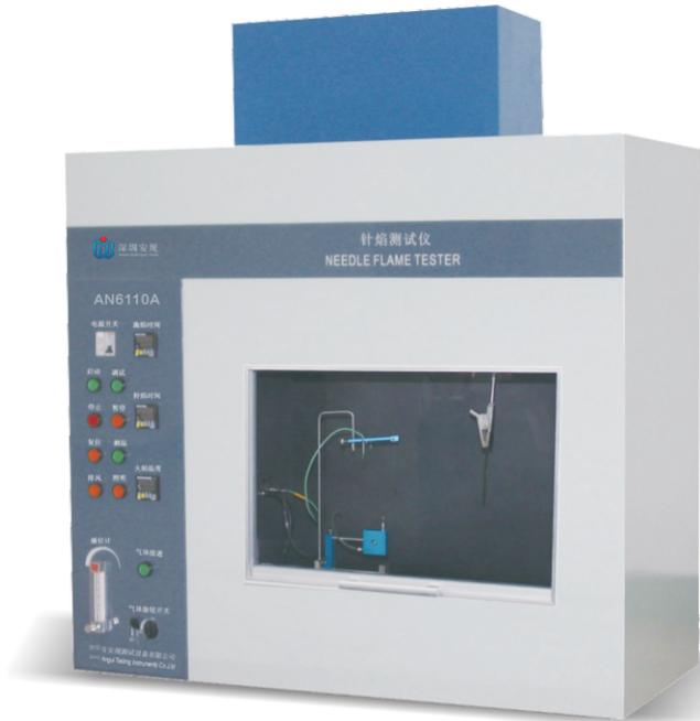
在产品中，由于故障条件使元件或零件过热，不良接触等情况下均可能引起火焰，它可能又辐射到附近的零件上，针焰试验是模拟产品内部在故障条件下所产生的小火焰，用模拟技术评定着火危险性。对于小零件（或元件）灼热丝试验或水平一垂直燃烧试验方法不适合时，可引用针焰试验方法。如果试验样品在进行灼热丝试验时起燃，则所产生的燃烧危险情况还需用针焰试验。
