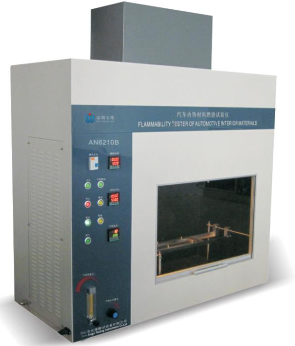
汽车内饰材料燃烧试验仪是依据GB 8410-2006、TL1010、GM6090M、DIN7520、GM9070P、FMVSS 302、JIS D 1201、JASO M403、ISO 3795、ASTM D5132等标准，适用于汽车（轿车、多用乘用车、载货汽车和客车）内饰材料水平燃烧特性的评定。
