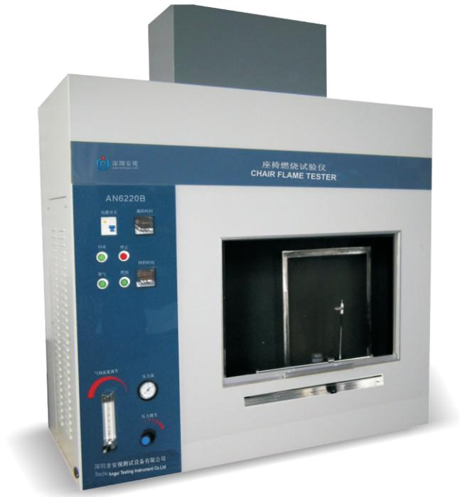
座椅燃烧试验仪符合：BS 5852第1,2部分、ISO 8191第1,2部的要求。用于对座椅软垫合成物吸烟者的材料易燃性能的水平、垂直可燃性试验。产品箱体外壳为钢材结构，并配置了透明观察窗，数显计时器记录施焰、持焰时间，整机外形美观，使用方便，性能可靠。
