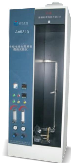
单根电线电缆垂直燃烧试验仪是GB/T18380.11.12.21.22、IEC60332-1、GB/T5169.14、GB/T19666等标准规定的模拟单根电线电缆燃烧性能安全试验项目。
