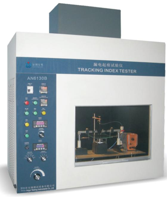
在电器产品受潮湿和杂质环境的影响下，不同极性带电部件之间或带电部件与接地金属之间可能会引起绝缘上的漏电，产生的电弧对电器造成击穿短路或由于放电使材料电蚀损，甚至起燃导致火灾。漏电起痕试验就是模拟上述情况对绝缘材料进行的一种破坏性试验，用以测量和评定在规定电压下，绝缘体在电场和含杂质水的作用时的相对耐漏电起痕性，适用于电工电子产品、家用电器的固体电器绝缘材料及其产品，如：继电器插座、转换开关盖、接触器等。
