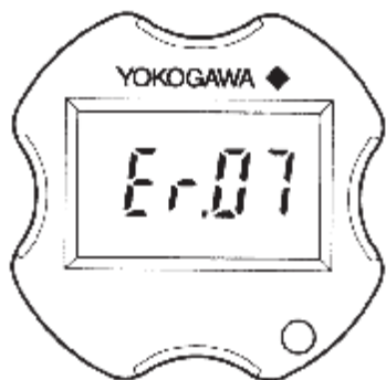
图 7.5.1 用内藏指示计检查故障
