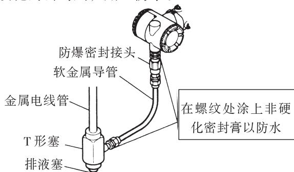
图 6.4.2b 配线用隔爆密封接头
