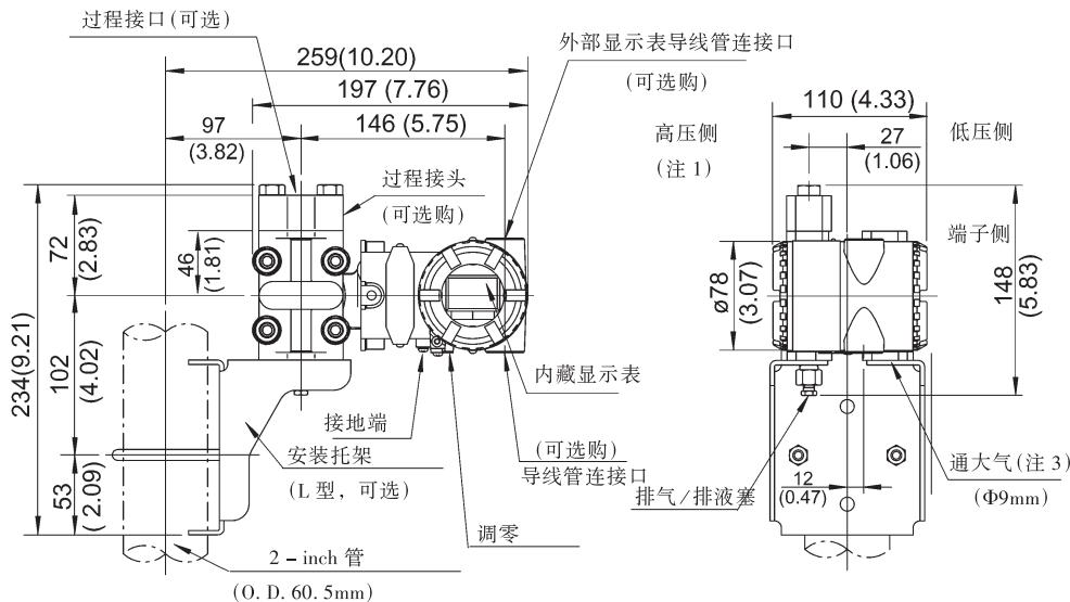
水平配管安装方式(安装代码 9)(对于代码 8, 参考后面注释)
