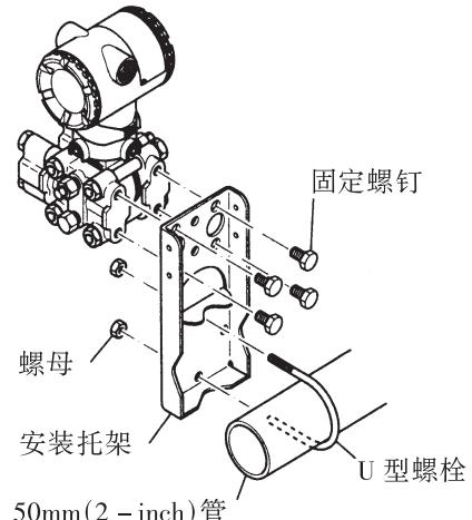
4. 2. 1 变送器的安装(水平配管)
