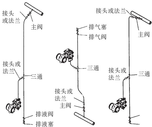
图 5.2 配管示意图
