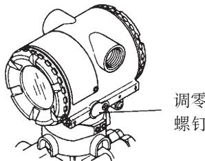
参数检查完毕，即可着手于调零操作，进行调零操作时，过程压力值不必非得设定为测量范围下限(%)，此时可将变送器输出信号调态到高精度，压力测定仪的实测值一致。
