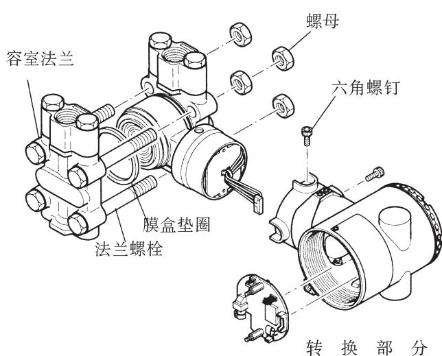
图 9.4.2 测压部的安装与拆卸
