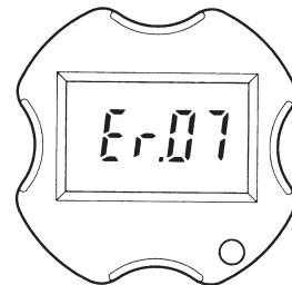
图 8.5.1 用内藏指示计检查故障
