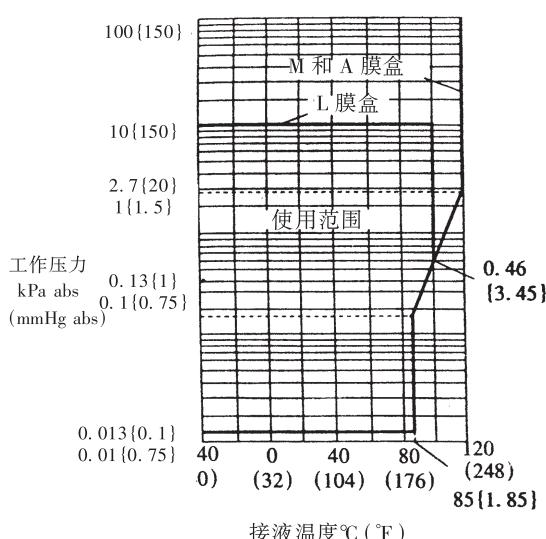
图 1 工作压力和过程温度关系图
