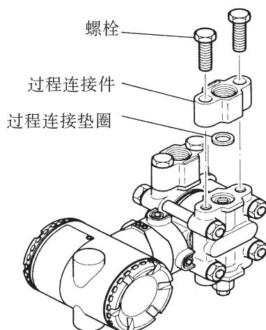
图 9.4.3 过程接头的拆卸与安装
