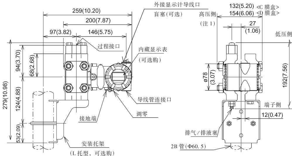
水平配管安装方式(安装代码 9)(对于代码 8, 参考后面注释)
