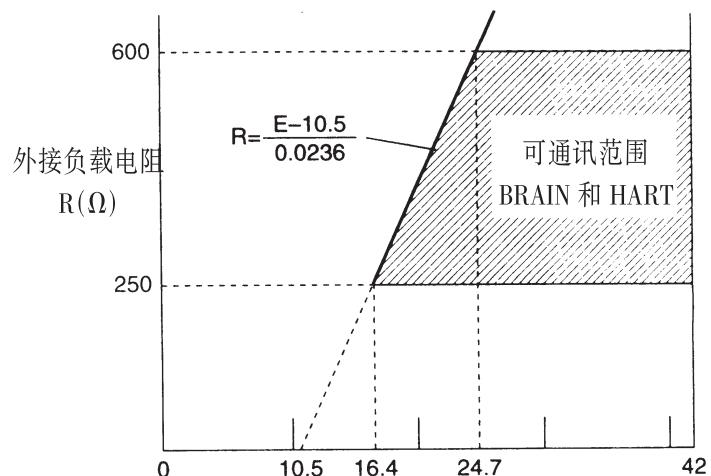
图 6.6 电源电压与外接负载电阻之间关系
