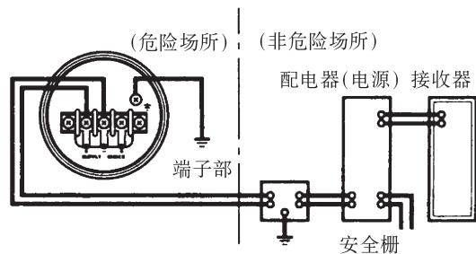
图6.4.1b 变送器与配电器的连接
