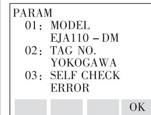
初始数据页显示当前 Dpharp 的检查结果。进入参数页，按[F2](DIAG)键，进入检查页 (C60: SELF CHECK)，当发现故障时，在检查页上显示出错误信息的提示。
