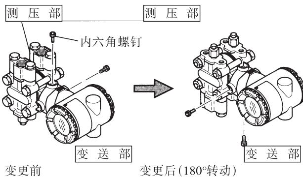
图 4.4 高低压转换前和转换后
