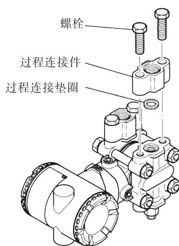
图 9.4.3 过程接头的拆卸与安装
