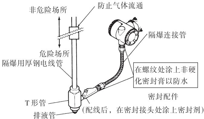
图 6.4.2c 使用隔爆金属导线管配线
