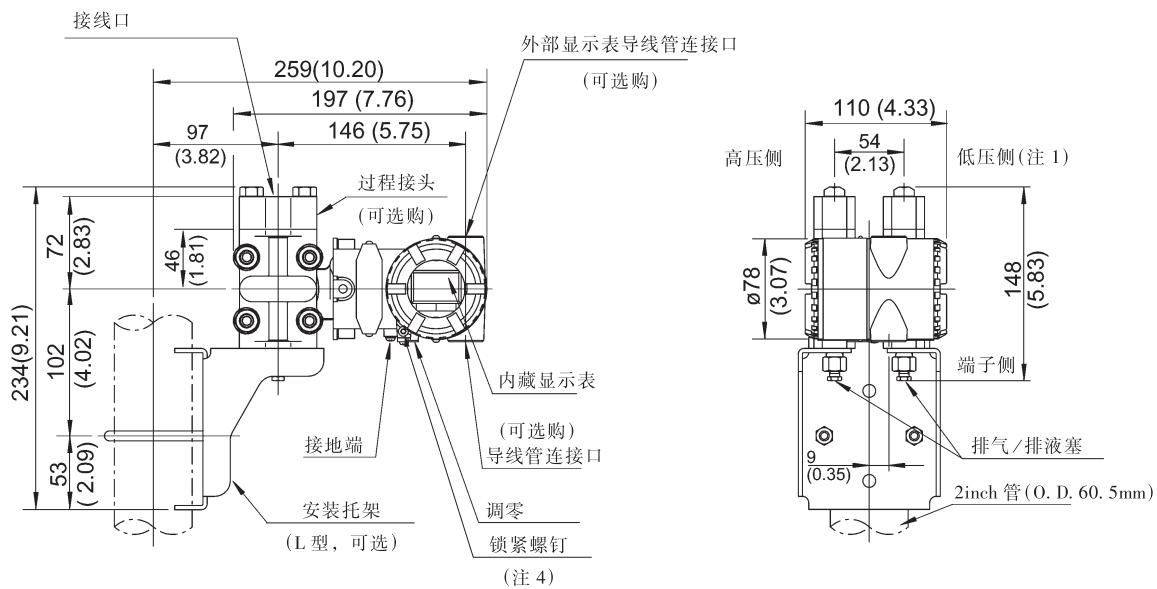
水平配管安装方式(安装代码 9)(对于代码 8, 参考后面注释)
