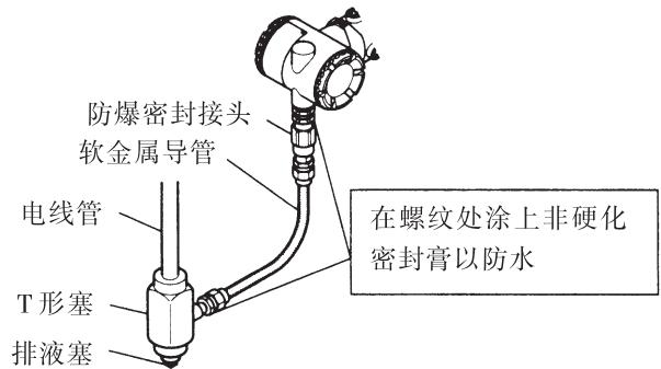
图 6.4.2b 配线用隔爆密封接头
