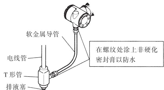
图 6.4.2a 配线用金属软管
