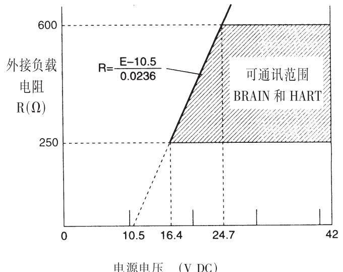
图 6.6 电源电压与外接负载电阻之间关系
