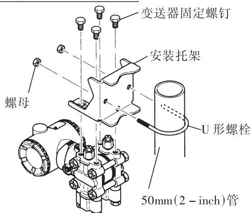
图 4. 2. 2 变送器的安装(垂直配管)
