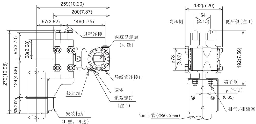
水平配管安装方式(安装代码 9)(对于代码 8, 参考后面注释)
