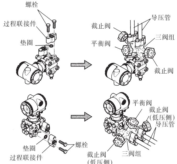
图 5.1.1c 三阀组(直接连接型)
