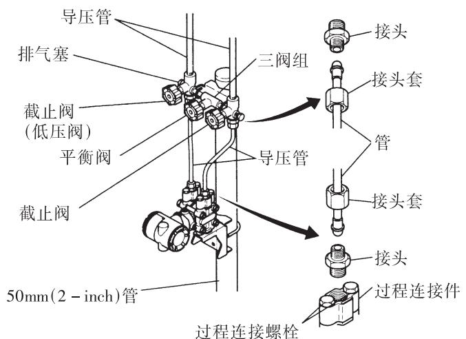
图 5.1.1b 三阀组(配管型)
