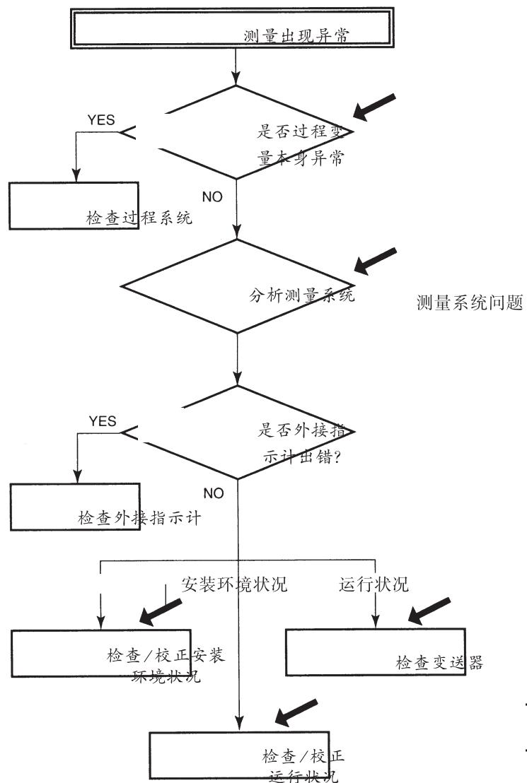
图 9.5.1 基本流程及自诊断
