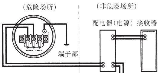
图 6.4.1a 变送器与配电器的连接
