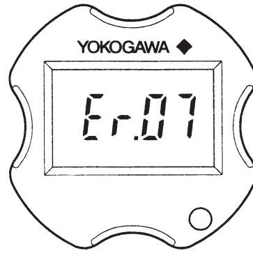
图 8.5.1 用内藏指示计检查故障
