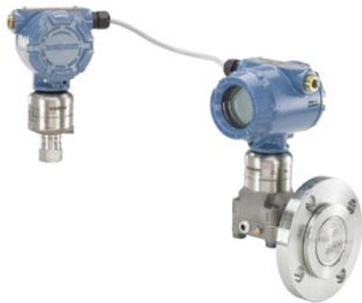
3051S ERS™ 系统是一种灵活的双线 4–20 mA HART 架构，可使用以非专用电线互连的两个压力传感器通过电子方式计算差压 (DP)。
