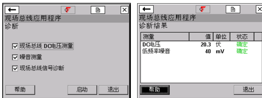
图 4-8. 现场总线诊断窗口示例
