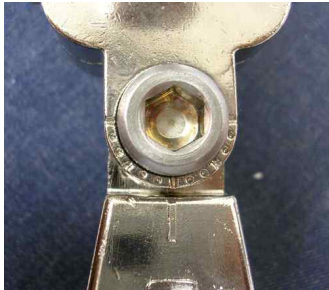
左右角度调整连接部(使用M10-25)
