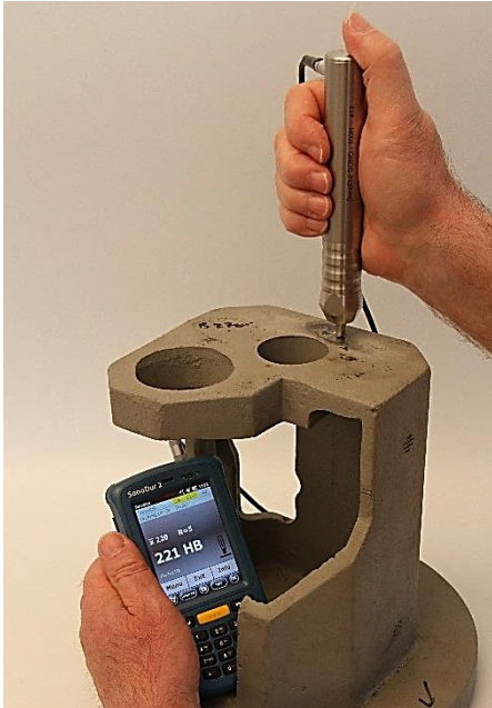
快速精确的硬度检测 SonoDur2 在 GGG50 铸铁上的检测 应用软件可以与电脑同步显示
