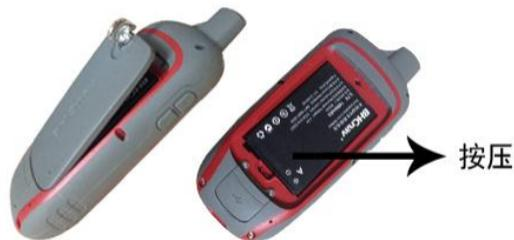
转 90°，取下后盖。将锂电池有金属触点的一端对准电池仓内的金属触点先放入电池仓，然后按压另外一端，将锂电池全部放入电池仓。装上后盖压紧，顺时针旋旋转 90° D 型金属环，拧紧即可。
