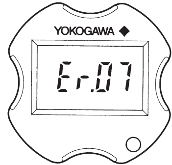
图 8.5.1 用内藏指示计检查故障
