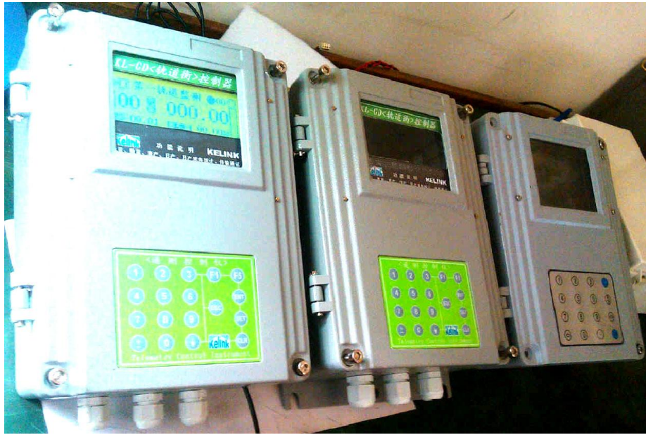
装车控制器（铝合金防水外壳型）
