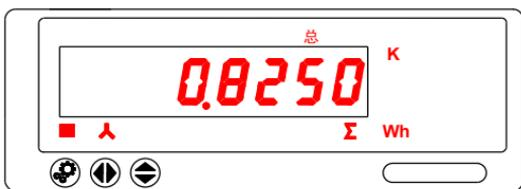
说明：总时段总分时有功电能为 0.8250KWh，单位为 KWh，和 M 组合成兆瓦时。若具有复费率功能，可查看峰平谷尖总时段有功电能。
