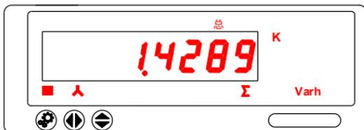
说明：总时段总分时无功电能为 1.4289Kvarh，单位为 KVarh，和 M 组合成兆乏时。若具有复费率功能，可查看峰平谷尖总时段无功电能。
