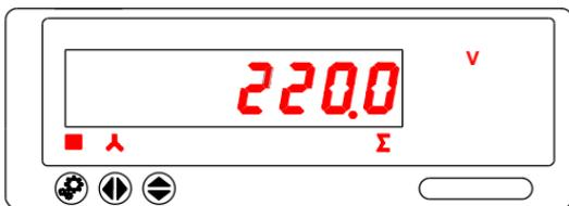
说明：平均相电压为 220.0V，显示单位伏，和 k、M 组合成千伏、兆伏，在 3P3L 或 3V3A 线制下，不测量相电压，无此屏显示。
