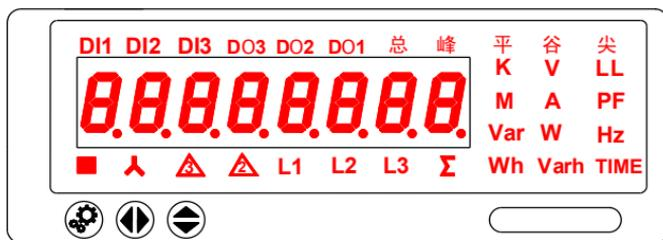
说明: 显示数据使用 8 位数码管, 显示单位或类型使用 23 个指示灯, 显示仪表工作状态使用 8 个指示灯。各指示灯的含义如下表 7 所示:
