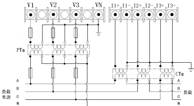
4-3. 三相四线系统，采用 3CT，无 PT 连接方式的接线图（适用于 3P4L，见 6.3.2 的设置仪表参数）
