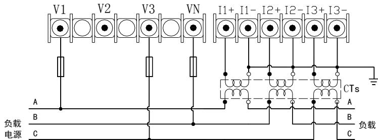
4-1. 三相四线系统，采用无 CT，无 PT 连接方式的接线图（适用于 3P4L，见 6.3.2 的设置仪表参数）
