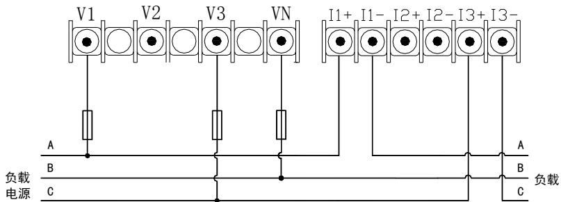
2-2. 三相三线系统，采用 2CT, 2PT 方式的接线图（适用于 3P3L，见 6.3.2 的设置仪表参数）
