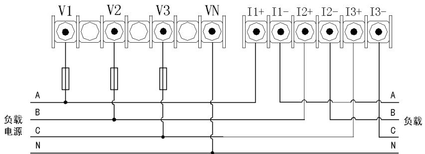
4-2. 三相四线系统，采用 3CT，3PT 连接方式的接线图（适用于 3P4L，见 6.3.2 的设置仪表参数）
