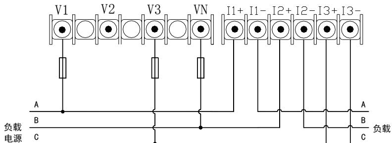
3-2. 三相三线系统, 采用 3CT, 2PT 方式的方式接线图(适用于 3V3A, 见 6.3.2 的设置仪表参数)
