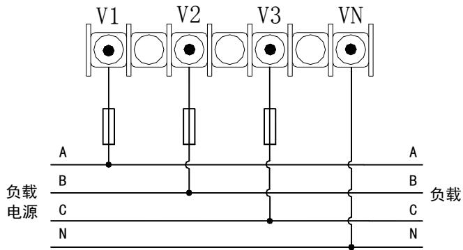
2-4. 三相四线系统，采用 3PT 方式的接线图（适用于 3P4L，见 6.3.2 的设置仪表参数）
