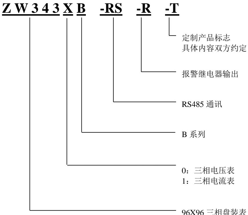
本说明书所提及的有关电压参数的说明针对 **ZW3430B**，所提及的有关电流参数的说明针对 **ZW3431B**
