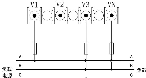
2-2. 三相三线系统，采用 2PT 方式的接线图（适用于 3P3L，见 6.3.2 的设置仪表参数）
