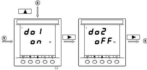
第一行显示哪个数字量，第二行显示该数字量的当状态，ON 表示动作，OFF 表示恢复。
