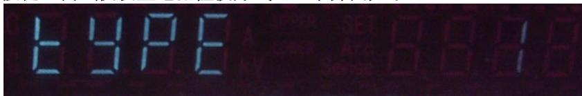
按“向上”键或“向下”键改变检波方式；检波方式分四种：①为测量直流电流；②为真有效值检波；③为平均值检波；④为峰值检波；
