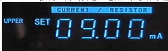
标志位“UPPER SET”亮，并且左边第一位闪烁，表示这一位被选中，可通过按上、下、左、右键对上图的四位数进行设定。在设置电流上限的同时，漏电流测量量程也随之确定。当设定值 $\leq 0.2\text{mA}$ 时，测量范围为 200 $\mu\text{A}$  档，200 $\mu\text{A}$  档时，数字后面的单位 mA 没有显示；当设定值 $\leq 2\text{mA}$ 时，测量范围为 2mA，当设定值 $\leq 20\text{mA}$ 时，测量范围为 20mA。
