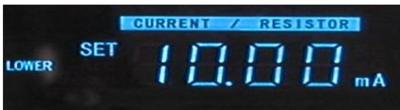
设置电流下限时，标志位“LOWER SET”亮，参数设定操作步骤同上限参数设置。
