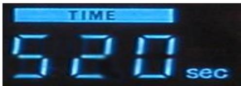
时间显示区域时间个位开始闪烁。用户通过上、下、左、右键可设定(0.0-999)s 参数值，当测试时间小于 99.9 时，时间设置有小数点，分辨率为 0.1s；当设置时间大于 100s 时，时间设置没有小数点，分辨率为 1s。
