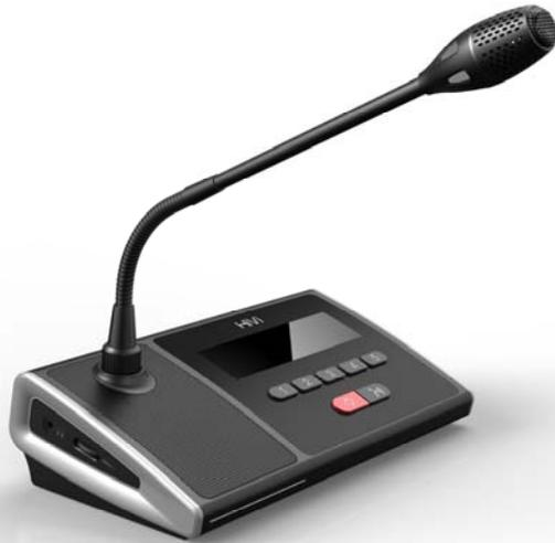
主席可以通过 256\*64 图形点阵 LCD 屏操控整个会议，可由主席发起报到、表决、评议、选举及讨论等议题，报到和表决结果可实时在 LCD 屏上显示；支持最大 32 路同声传译，支持服务呼叫功能；每台会议终端具备全球唯一的 ID 号，方便设备的安装调试及有序管理；同时会议终端通过主机实现控制软件的在线升级。
