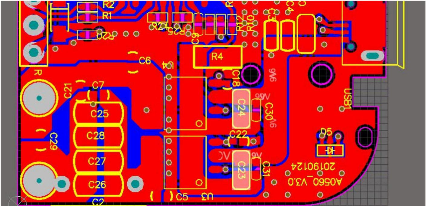
2、采样电阻的 GND 与系统的 GND 之间连接要良好，多打过孔连接到系统 GND；采样信号线尽量跟其他信号隔离，防止其受到干扰，C10 要靠近 IC 引脚起滤波作用。
