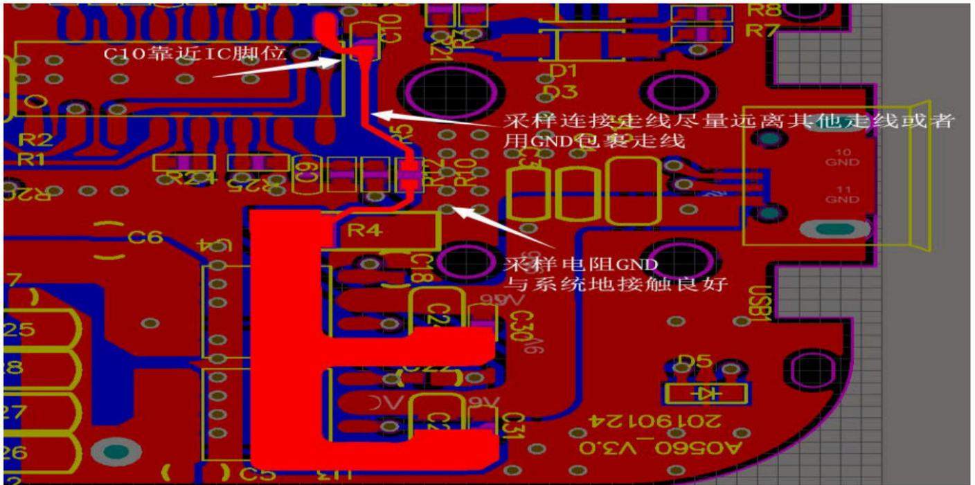
3、线圈和谐振电容敷铜面积尽量要大，保证路径环路面积尽可能短。
