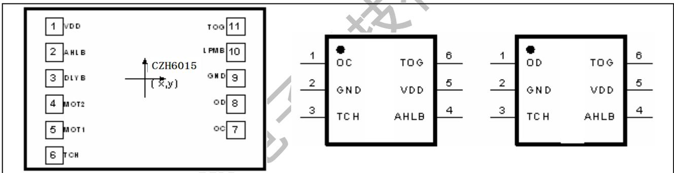
图 1 Die / (SOT23-6L) 引脚示意图
