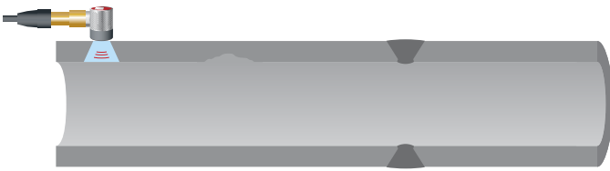
常规UT技术只能检测传感器下面或附近的局部区域。
