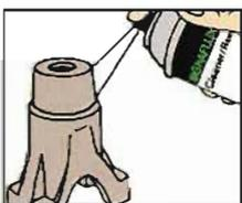
预先清理被测区域。喷洒清洗剂/去除剂，并用擦拭布擦干。
