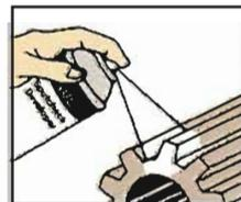
将显像剂薄薄地、均匀地喷洒在工件表面。
