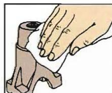
将清洗剂/去除剂喷在擦拭布上，将工件表面残留的渗透剂擦干净。
