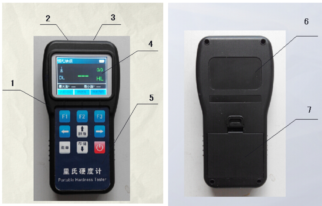
1 外壳 2 通信插座 (USB) 3 冲击装置插座 4 液晶显示屏 5 键盘 6 铭牌 7 电池仓盖
