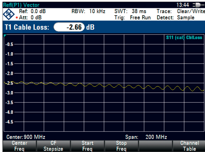
单端口电缆损耗测量。
