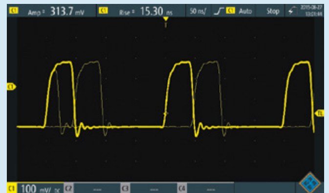
R&S®ScopeRider 高速采集系统的波形捕获率高达 50000 waveforms/s，能够发现罕见的异常信号。
