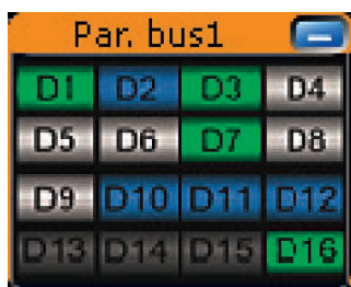
数字通道的信号状态显示在信号栏图标中，与示波器设置无关。
