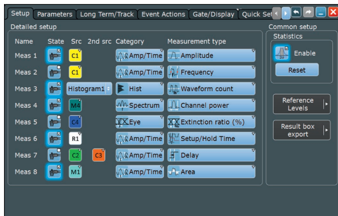
在 R&S®RTE 示波器中，可以配置并同时激活多达 8 种自动测量。
