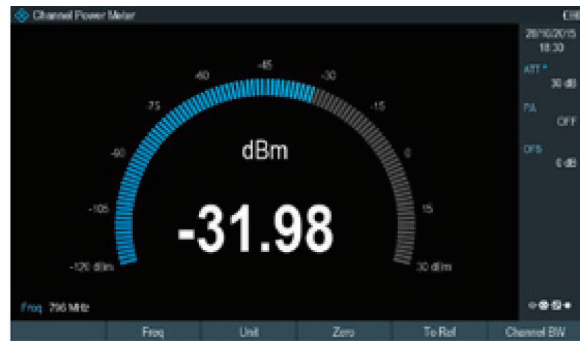
内置信道功率计屏幕 (R&S®FPH-K19)。
