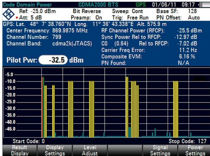
R&S®FSH-K46E 选件可用于码域功率测量，以便进行深入的分析。该选件能够以图形方式显示占用信道和未占用信道的信道功率。由此产生的摘要提供关键信号参数概览，比如 RF 信道功率、信道功率、Rho 和复合 EVM。信道功率相对于总功率，或者相对于导频信道功率。
