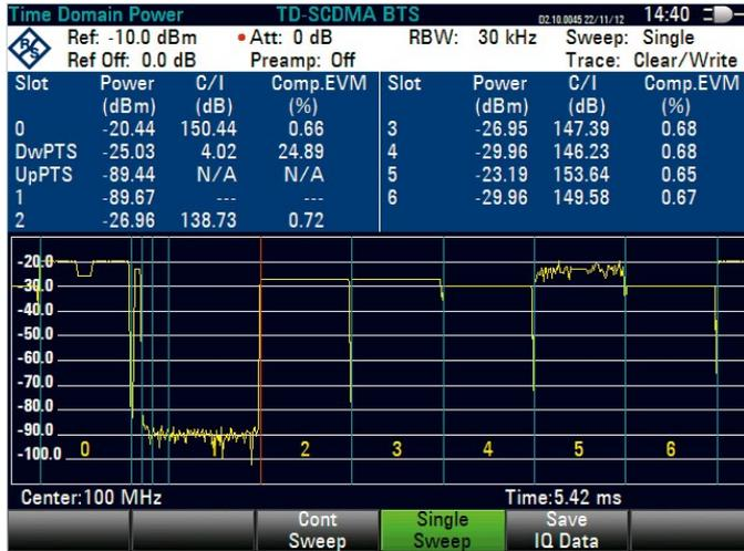
R&S®FSH-K48E 测量应用能够对 TD-SCDMA/HSDPA 信号进行快速和可靠的深度分析。时域功率显示给出 TD-SCDMA 子帧内每个激活时隙的接收功率、C/I 和复合 EVM。结果同时用表格和图形显示。显示线和编号帮助用户轻松核查每个子帧的功率和定时是否满足规范要求。
