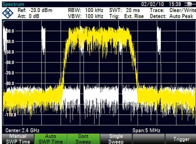
分析 GSM/GPRS/EDGE 发射信号。
