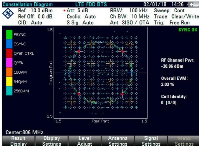
R&S®FSH 支持 LTE Advanced 载波聚合，可以同时显示最多三个 LTE 载波的测量结果。简明的 pass/fail 指示可以帮助用户检测天线和线缆安装中的缺陷。使用 R&S®TS-EMF 测量系统的同向天线，R&S®FSH-K50/-K51 还能够测量 LTE 信号的电场强度。R&S®FSH-K50E/-K51E 选件可用于进行深入的 LTE 分析。除了显示 EVM 值以外，该选件还带有星座图，能够以图形方式显示 LTE 信号质量。不同调制类型以及 LTE 信号分量可单独显示。LTE BTS 扫描仪可用于空间接口上的测量。这个扫描仪显示最多 8 个最强 LTE 信号的功率，并提供周边区域内所有 LTE 基站的快速概览。
