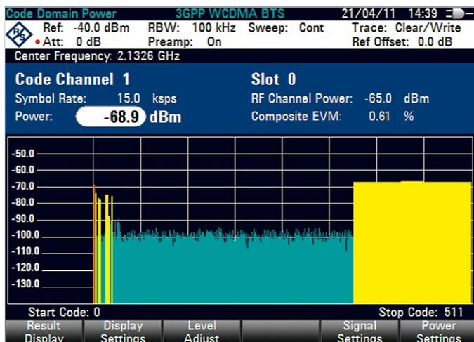
R&S®FSH-K44E 选件提供码域功率测量功能，以便深入进行 WCDMA/HSDPA/HSPA+ 分析。该选件能够以图形方式显示已占用码道和未占用码道的信道功率。由此产生的摘要提供关键信号参数概览，比如 RF 信道功率、编码信道功率和复合 EVM。码域信道列表提供符号率、含相关扩频因子的信道编号，以及信道类型的自动检测和显示等其他信息。
