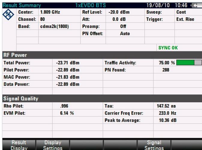
借助 R&S®FSH-K47E 选件，用户能够进行深入的 1xEV-DO 测量。R&S®FSH 提供多达 8 个 PN 偏置以及相应功率，以便用户对相邻基站快速浏览。时域内的突发功率测量可用于核查 1xEV-DO 帧功率和帧定时是否符合标准规范。
