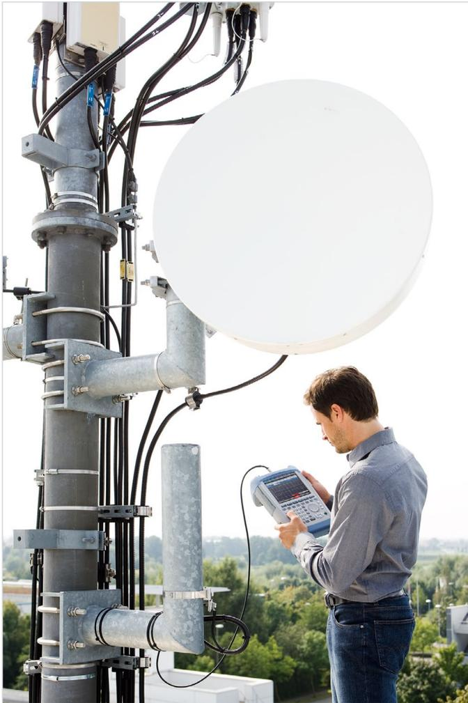
R&S®FSH 是一款手持式频谱分析仪，依据不同的型号、安装选件可以实现不同的功能，比如功率计、电缆和天线测试仪、双端口矢量网络分析仪。它提供了非常重要的 RF 分析功能，RF 技术服务人员或安装和维护团队可使用这些功能解决日常的测量任务。比如，它可用于发射机的维护 and 安装，检查电缆和天线，评估广播、无线通信及服务中的信号质量，测量电场强度，或者用于简单的实验室应用。R&S®FSH 可以快速、可靠地执行这些任务，而且测量精度很高。
