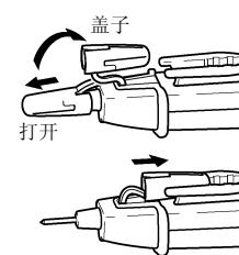
使用本仪器时, 如图所示, 打开盖子并固定于反面。
